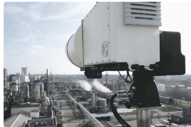
Auf Basis der FTIR Spektroskopie können mit Scanfeld mehr als 400 Substanzen automatisch digital erfasst und kartiert werden, rund um die Uhr und unabhängig vom Wetter.
