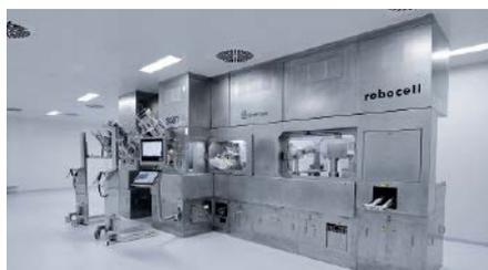
▲ Robocell ist eine vollautomatisierte aseptische Füll-Linie mittels Robotertechnik.
