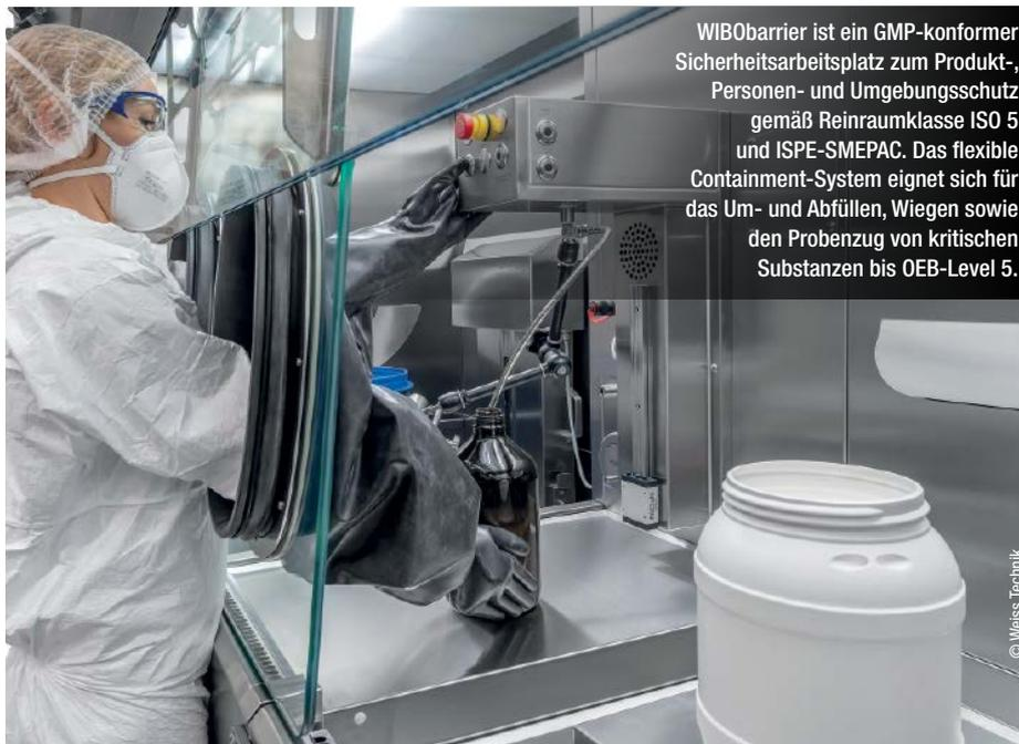
WIBObarrier ist ein GMP-konformer Sicherheitsarbeitsplatz zum Produkt-, Personen- und Umgebungsschutz gemäß Reinraumklasse ISO 5 und ISPE-SMEPAC. Das flexible Containment-System eignet sich für das Um- und Abfüllen, Wiegen sowie den Probenzug von kritischen Substanzen bis OEB-Level 5.
