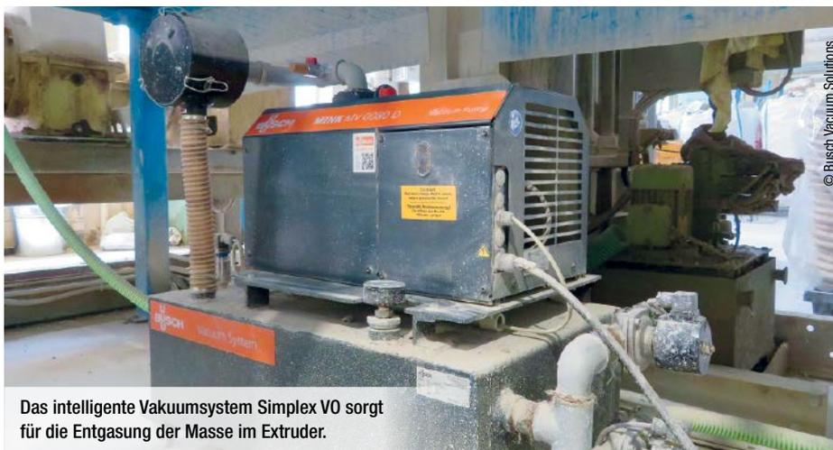
Das intelligente Vakuumsystem Simplex V0 sorgt für die Entgasung der Masse im Extruder.
