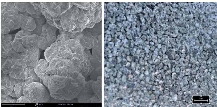
Abb. 2: Die Aufnahme einer geladenen Zinkelektrode mit 270 mAh/cm<sup>2</sup> mit Rasterelektronenmikroskop (links) und Makroskop (rechts) zeigt Schichten mit einer grobkörnigen Oberfläche, die aber eine hohe Dichte aufweisen und mechanisch stabil sind. Es entstehen keine Dendriten, die sonst zu Kurzschlüssen führen würden.
