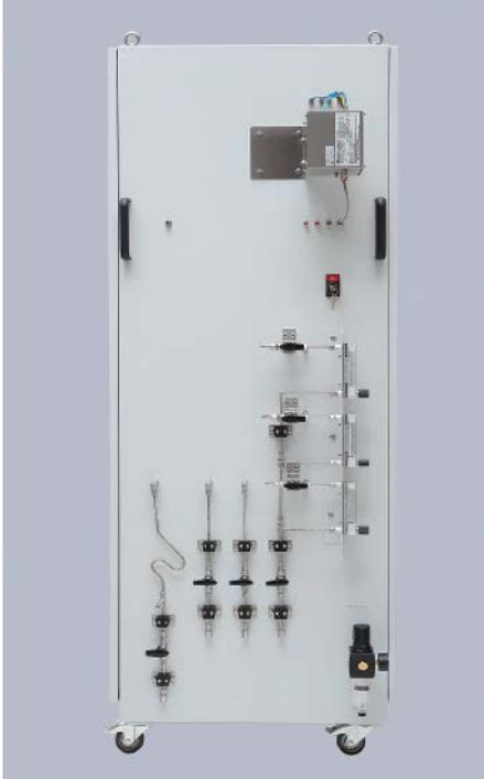
Speziell angefertigte Leitungsrohre als Zuleitung zu den Analysegeräten.
