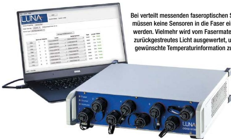
Bei verteilt messenden faseroptischen Systemen müssen keine Sensoren in die Faser eingebracht werden. Vielmehr wird vom Fasermaterial selbst zurückgestreutes Licht ausgewertet, um die gewünschte Temperaturinformation zu erhalten.
