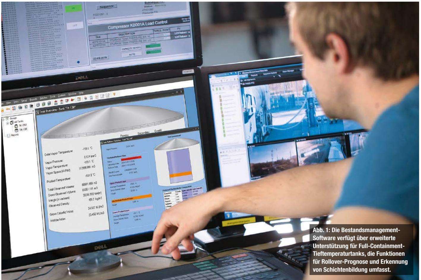
Abb. 1: Die Bestandsmanagement-Software verfügt über erweiterte Unterstützung für Full-Containment-Tiefemperaturtanks, die Funktionen für Rollover-Prognose und Erkennung von Schichtenbildung umfasst.
