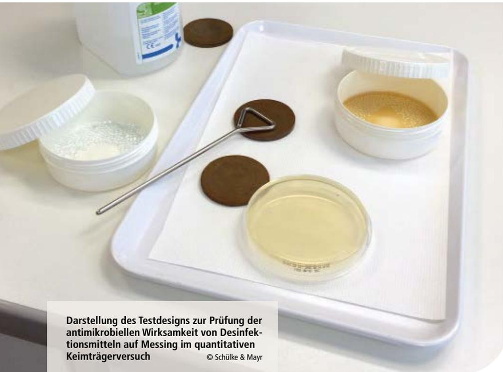
Darstellung des Testdesigns zur Prüfung der antimikrobiellen Wirksamkeit von Desinfektionsmitteln auf Messing im quantitativen Keimträgerversuch © Schülke & Mayr
