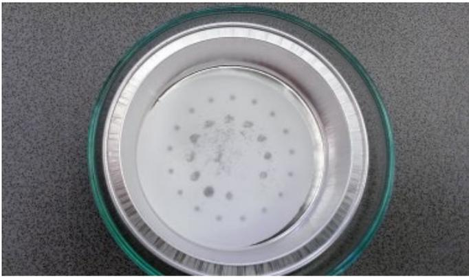
Abb. 4: Metallische Partikel im Filter
