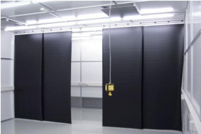
Abb. 1: Laserschutzfolien bieten nicht immer eine hinreichende Abschirmung, da der Wandanschluss an den Kabelkanälen nicht gewährleistet ist
