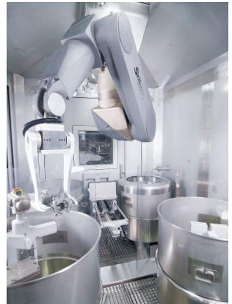
Ein an der Decke montierte Stäubli Roboter RX160 he – korrosionsbeständig sowie laugen- und säureresistent – übernimmt die komplette Teilehandhabung in der Reinigungsanlage.
