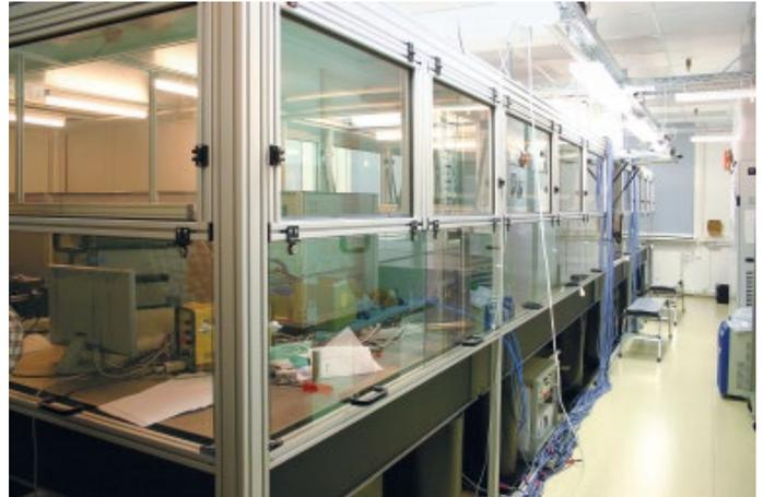
Abb. 3: Einhausung der optischen Tische im Forschungsbetrieb
