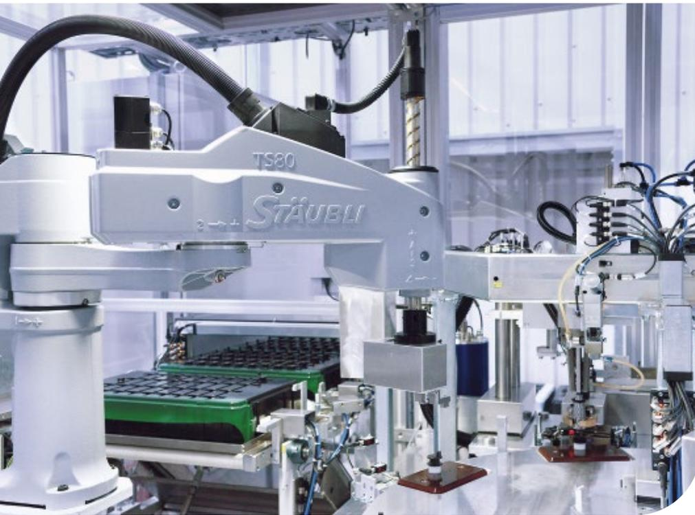
In der kompletten Anlage zur Montage von Gangstellersmodulen kommen ausschließlich Roboter, wie der TS80, in ESD-Ausführung gegen elektrostatische Aufladung zum Einsatz.
